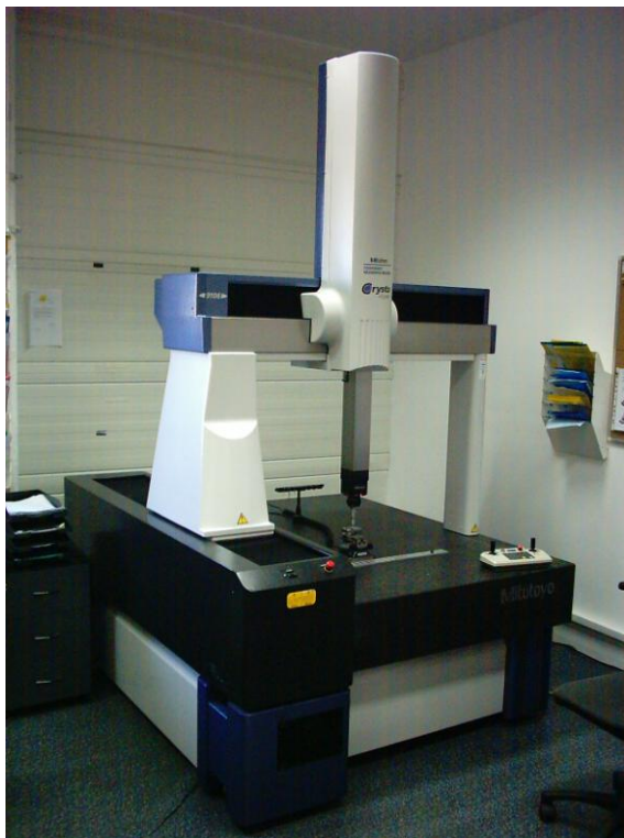
Fig. 2. Mașină de măsurat în coordonate 3D.
