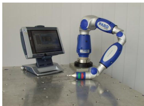
Fig. 1. Mașină de măsurat în coordonate 3D cu brațe portabile.
