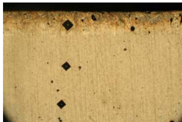
Fig. 26. Aspectul amprentelor de duritate pentru proba 2, MO 100x.
