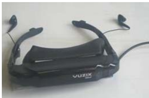
Fig. 6. HMD – casca de realitate virtuală 2d/3d VUZIX AV920.
