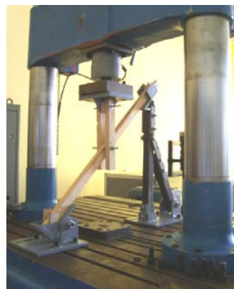
Fig. 4. Dispozitivul fixat pe mașina de încercări.
