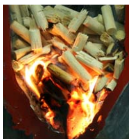
Fig.5 apparition d'une dénivellation du front de combustion dans le plan horizontal
