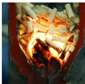
Fig.6 apparition d'une circulation verticale ascendante des gaz de combustion
