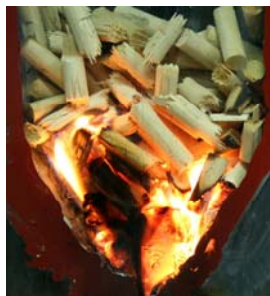
Fig.9 stabilisation d'un nouveau front de flamme horizontal
