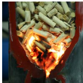
Fig.4 phase initiale, front de flamme horizontal
