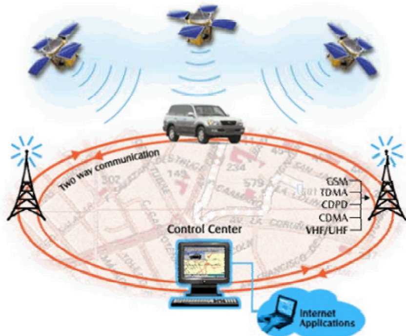
Fig. 4 Sistem de urmărire a autovehiculelor în trafic produs de Starcom [5].
