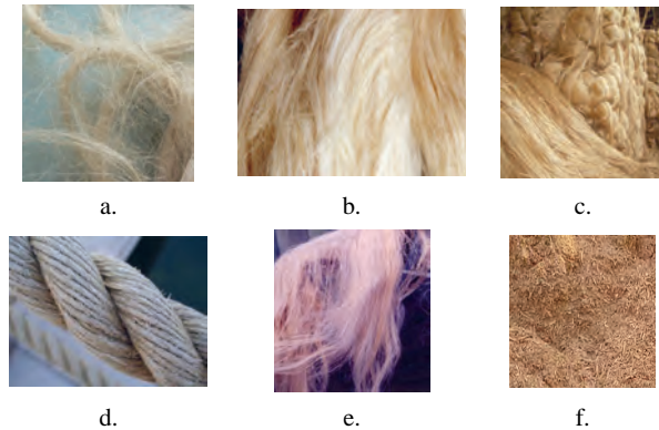
Fig. 2. Exemple de fibre vegetale de ranforsare a materialelor compozite utilizate pe plan mondial: a – in; b – cânepă; c – iută; d – banan; e – sisal; f – lemn.
