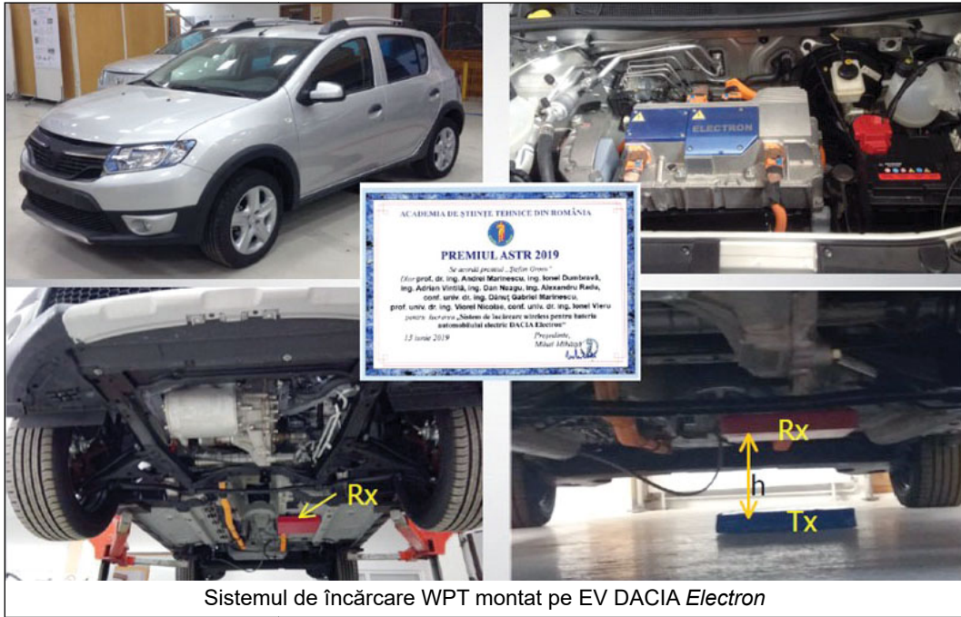
Sistemul de încărcare WPT montat pe EV DACIA Electron
