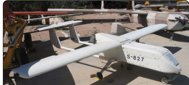
Fig. 1.1. Drona de tip Tadiran Mastiff , considerată prima dronă în accepțiunea modernă a conceptului
